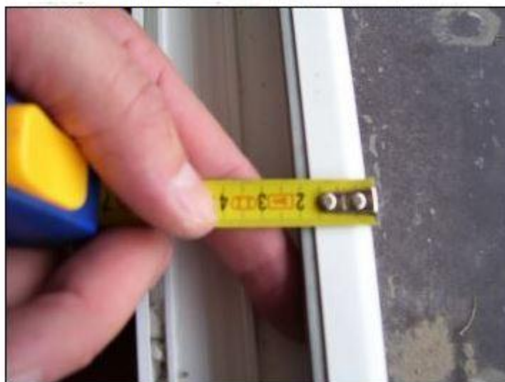
3 - zaměření hloubky rámu = rozměr B
